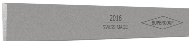
La **lame à tronçonner Supercoup® 2016** est composée de HSS de qualité. Elle permet d'usiner le laiton, l'aluminium, les aciers, les aciers de cémentation, les fontes et les aciers inox. La lame à tronçonner Supercoup® 2016 est compatible avec les porte-lames **Tripan® 235** et **Tripan® 2116**.
